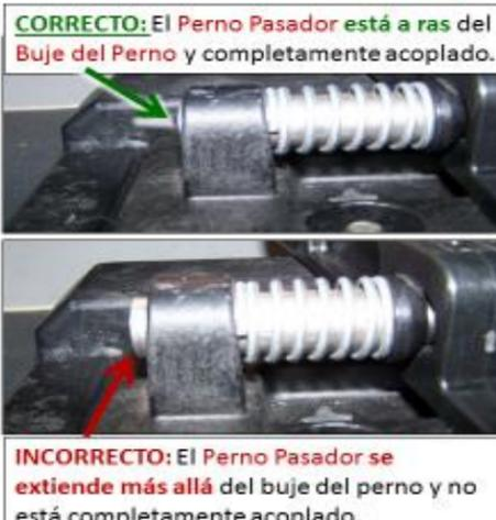
**CORRECTO:** El *Perno Pasador* está a ras del *Buje del Perno* y completamente acoplado.
